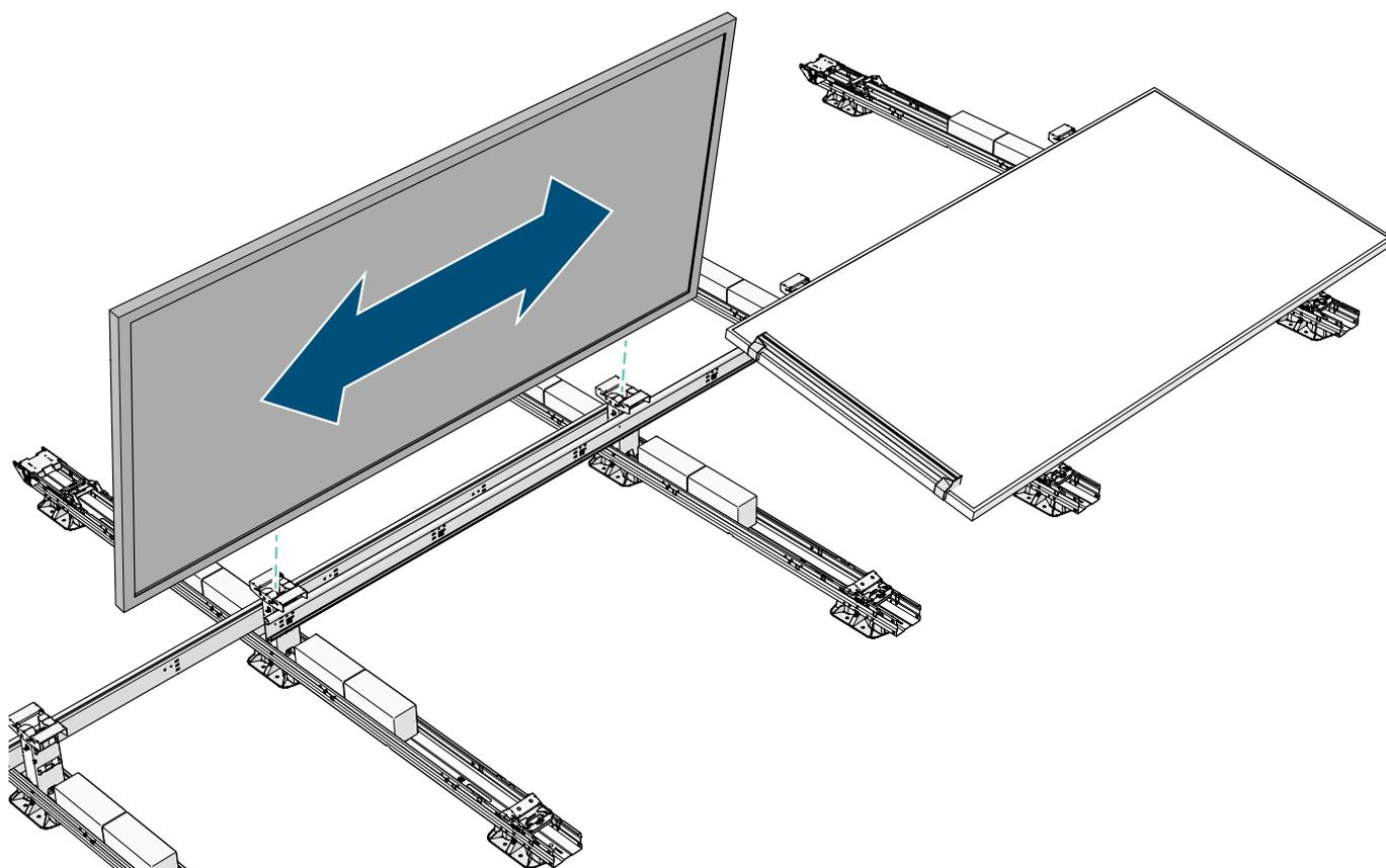
3 Com cuidado, incline o módulo fotovoltaico nos grampos do módulo.
