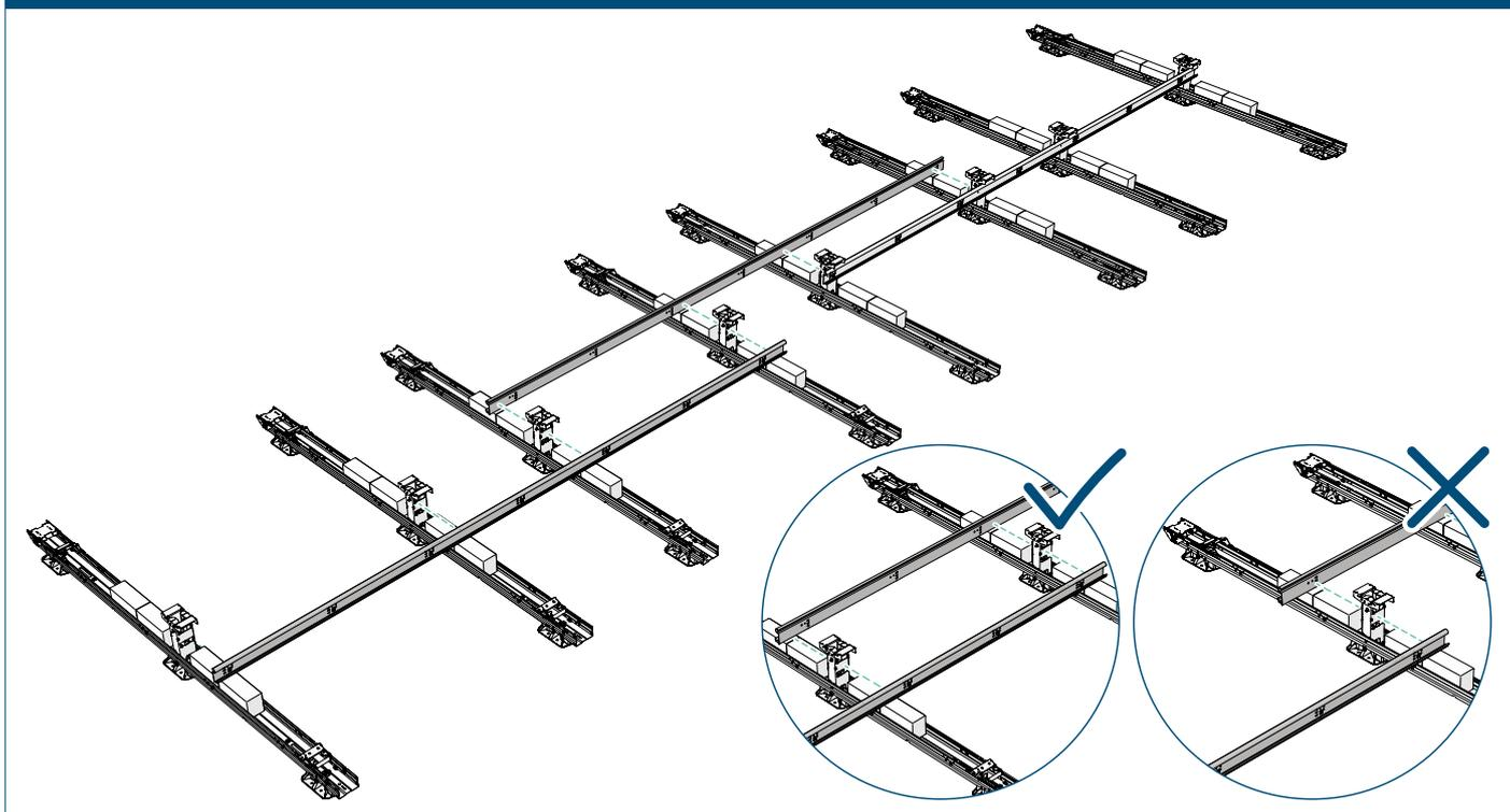
**3** Instale os suportes do cabo na parte de trás do estabilizador traseiro para transpor a distância entre dois estabilizadores
