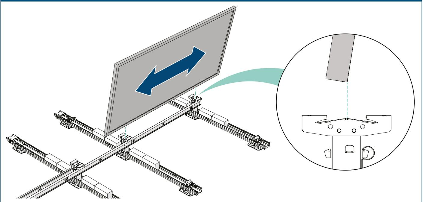
**2** Com cuidado, incline o módulo fotovoltaico nos grampos do módulo.
