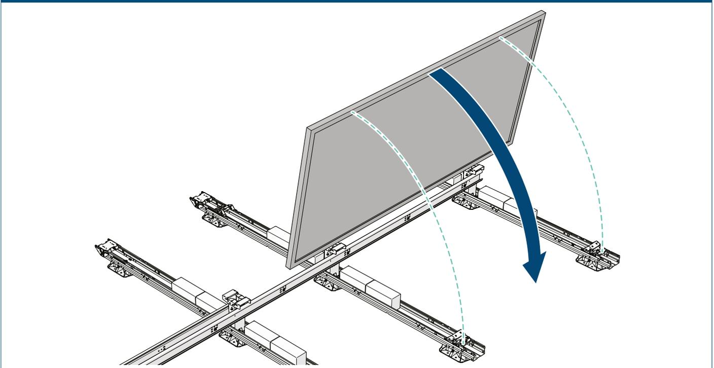
**3** Puxe o módulo fotovoltaico na sua direção, de modo a que a estrutura do módulo fotovoltaico engate nas bases altas.
