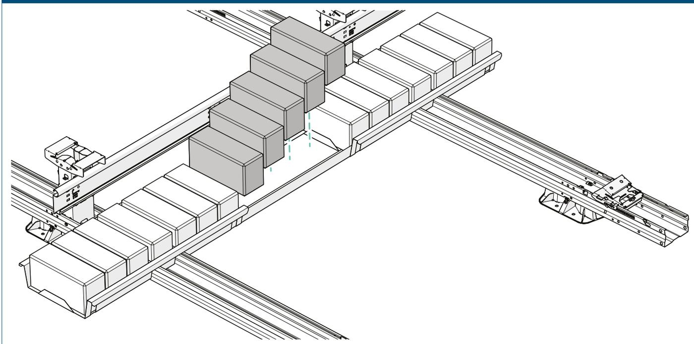
**5** Se o plano do projeto especificar mais do que um tabuleiro de lastro, deslize o tabuleiro de lastro exterior nas abas da unidade. Nesta fileira, pode colocar no máximo 3 tabuleiros de lastro seguidos.
