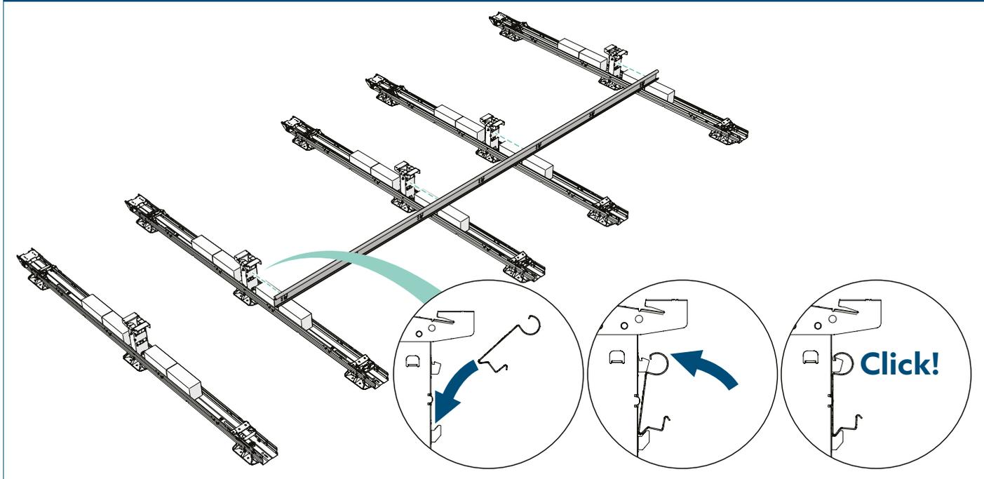
2 Encaixe os outros estabilizadores para que cada estabilizador se sobreponha ao estabilizador anterior sobre duas bases altas
