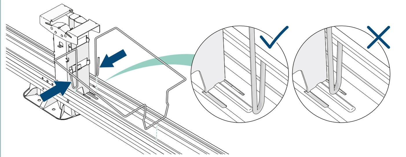
2 Encha o conector de lastro e, se necessário, a unidade, com lastro.
