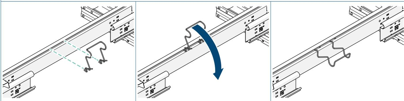
**4** Prolongue o segmento, encaixando outra unidade utilizando a união pré-instalada
