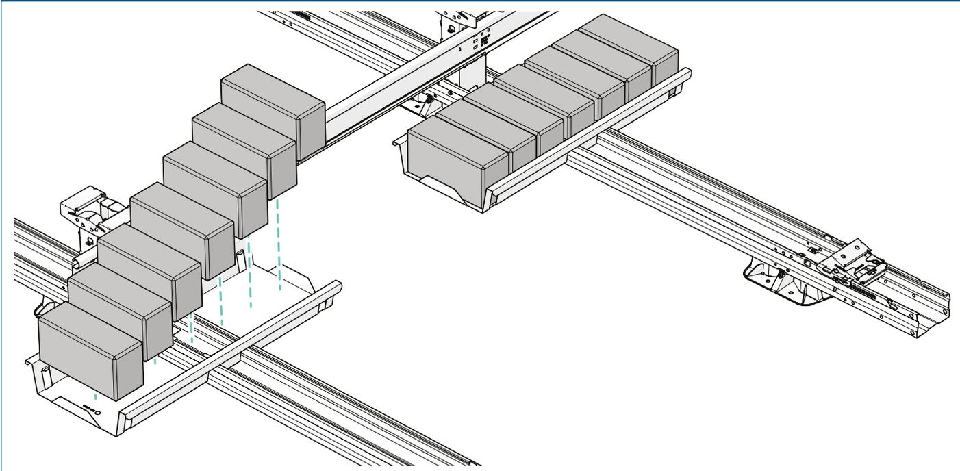
**3** Se o plano do projeto especificar mais do que um tabuleiro de lastro, deslize o tabuleiro de lastro exterior nas abas da unidade. Nesta fileira, pode colocar no máximo 3 tabuleiros de lastro seguidos.
