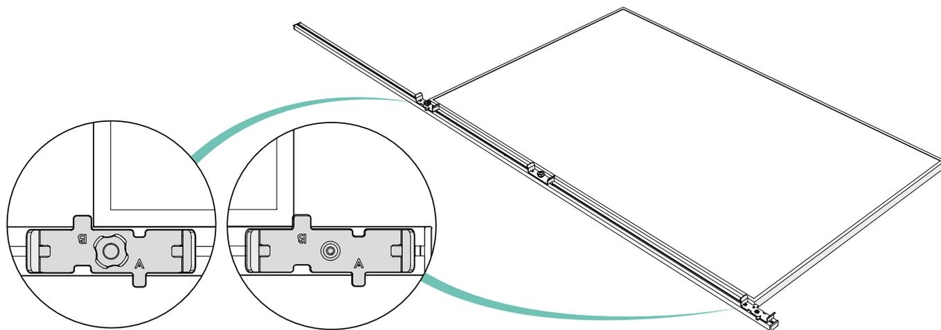
8 Ajuste o suporte central à distância "A", conforme especificado no plano do projeto.
