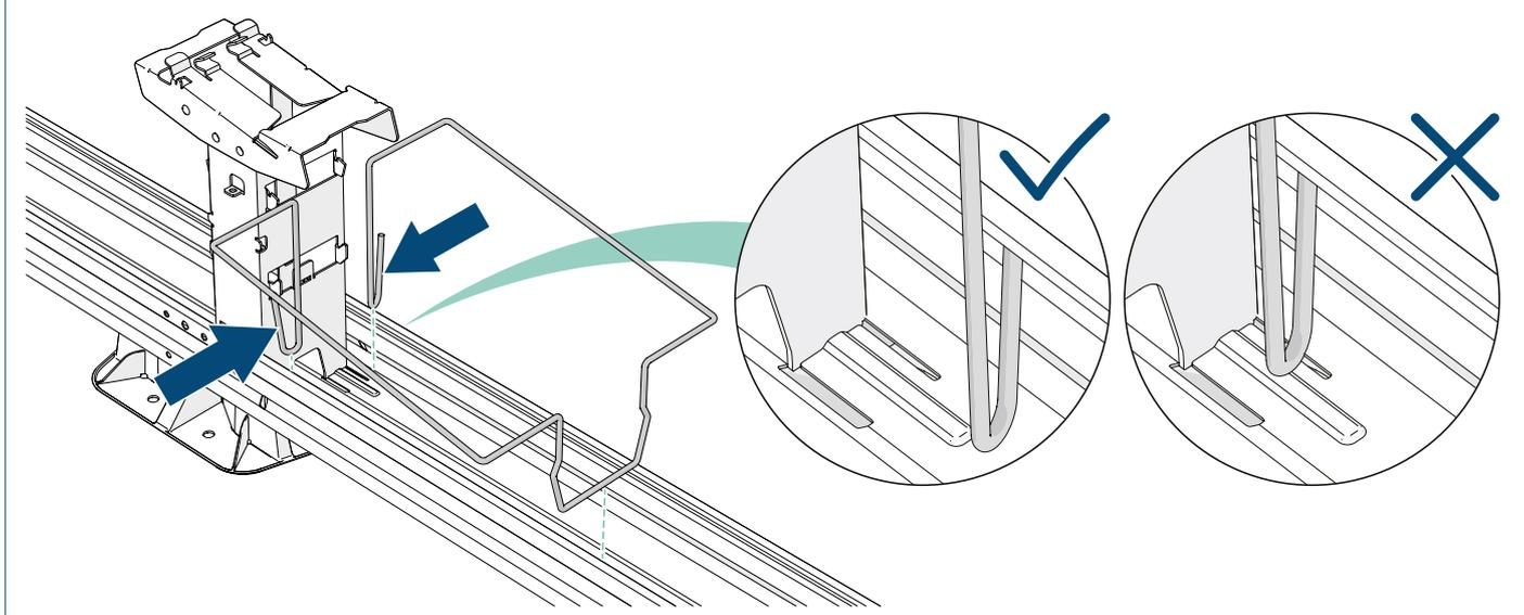
2 Placez des briques dans le bac de lestage et, si nécessaire, mettez-en dans l'unité.
