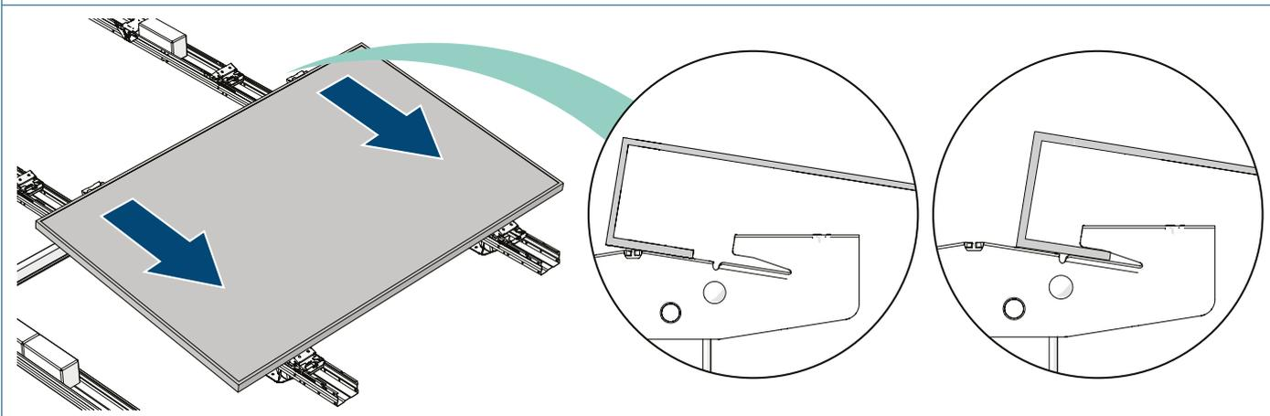
4 Tirez l'étrier de fixation vers vous jusqu'à ce qu'il ne puisse plus aller plus loin de façon à ce que les étriers soient accrochés sur le châssis du panneau solaire.
