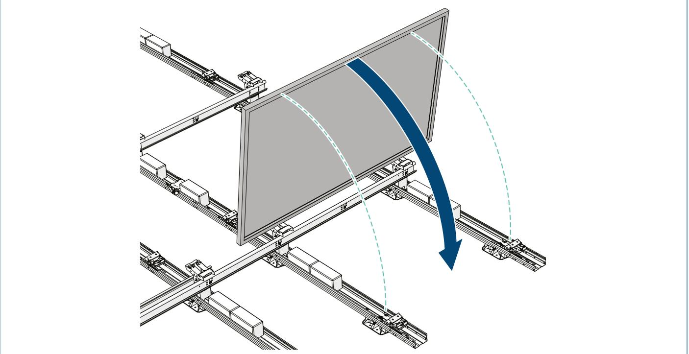
3 Tirez le panneau solaire vers vous de façon à ce que le châssis soit accroché sur les éléments de base hauts.
