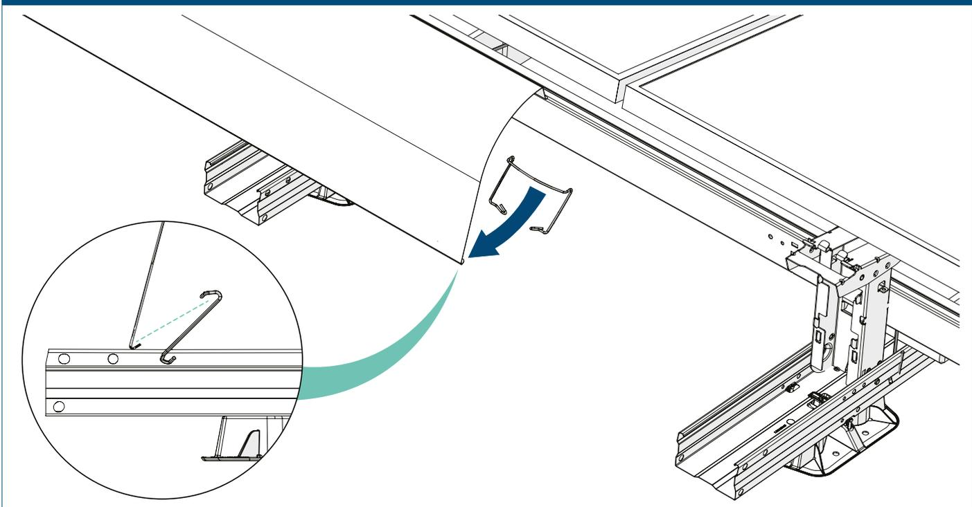
6 Faites glisser le clip du déflecteur arrière sur le bord jusqu'à ce qu'il repose sur l'unité.
