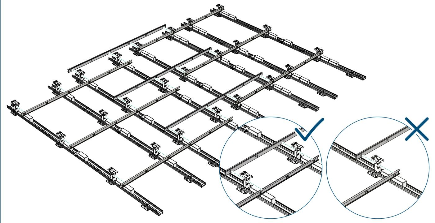
3 Installez les supports de câbles au dos du stabilisateur arrière pour combler l'espace entre deux stabilisateurs
