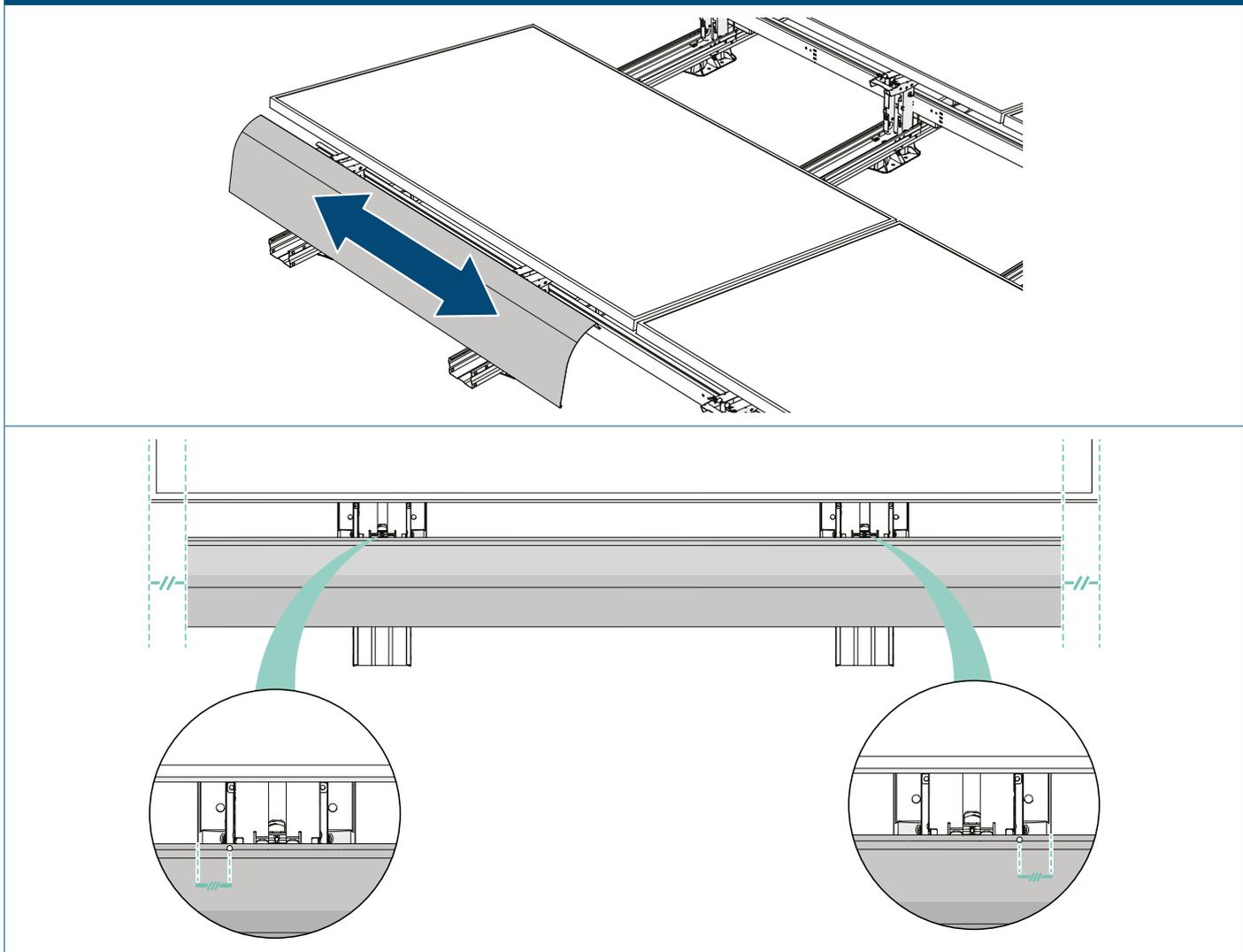
**i** Utilisez les trous situés dans la partie supérieure du déflecteur arrière pour le centrer correctement.
