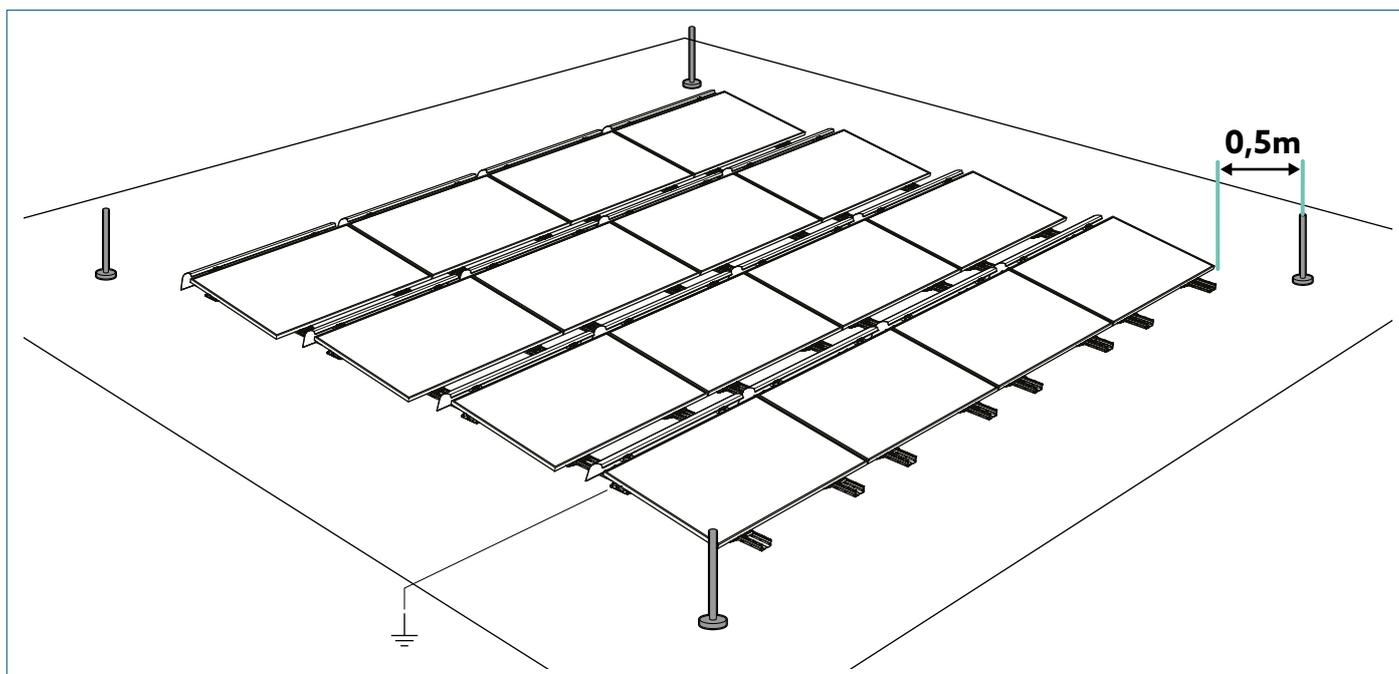
Die Blitzschutzanlage ist in der Regel mit Ableitern ausgestattet, die dafür sorgen, dass der Blitz nicht in die PV-Anlage einschlagen kann.
