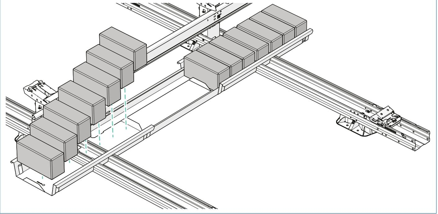
4 Füllen Sie die Ballastablagen-Verlängerung mit Ziegeln.
