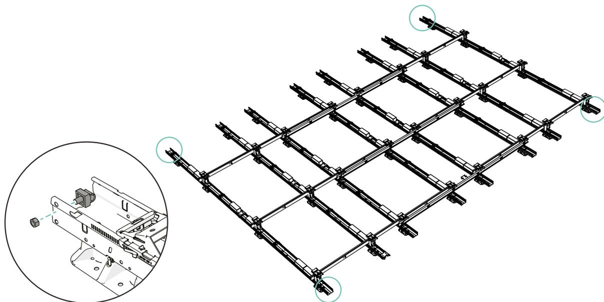
4 Befestigen Sie einen Aluminium- oder Kupferleiter mit einem Durchmesser von mindestens  $\varnothing 8$  mm an den vier Verbindern KSV 7.10. Befestigen Sie die vier Leiterdrähte an der Dachfalle
