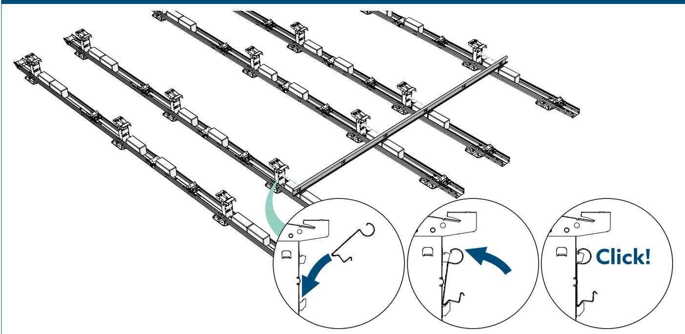
2 Befestigen Sie die anderen Stabilisatoren so, dass jeder Stabilisator den vorhergehenden Stabilisator über zwei hohe Baselemente überlappt.
