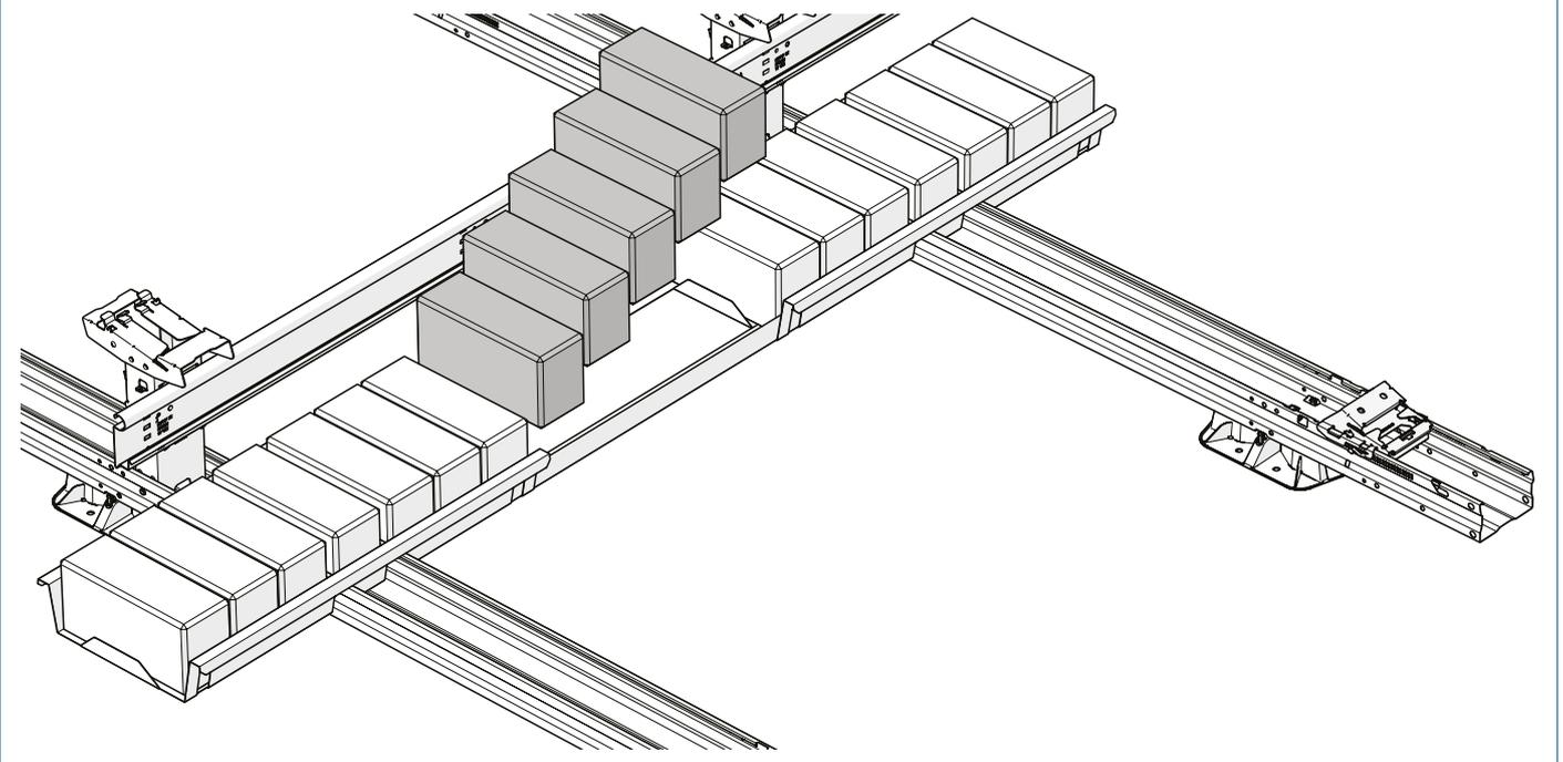
**5** Wenn mehr als eine Ballastablage im Projektplan vorgesehen sind, schieben Sie die äußere Ballastablage gegen die Laschen in der Einheit. In dieser Anordnung können Sie maximal drei Ballastablagen in einer Reihe platzieren.
