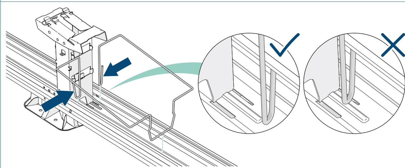
2 Füllen Sie den Ballastbügel und ggf. die Einheit mit Ziegeln.
