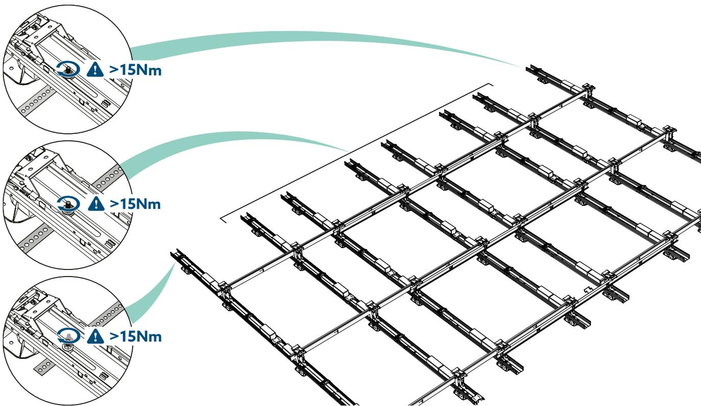
3 Bohren Sie an allen Ecken des Feldes Löcher mit  $\varnothing 10$  mm in die Module für den Anschluss an die Dachfalle und montieren Sie die vier Verbinder KSV 7.10
