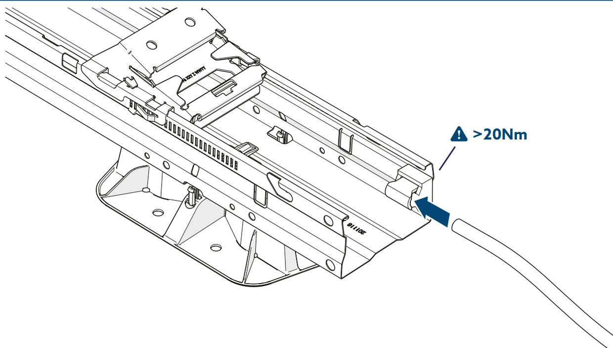
**i** Der Anschluss der PV-Anlage an die Dachableiterleitungen der Blitzschutzanlage kann nun hergestellt werden. Dazu wird ein Aluminium- oder Kupferrundleiter (Volldraht) mit einem Mindestquerschnitt von  $\varnothing 8$  mm (= 50 mm<sup>2</sup>) für die ankommende und abgehende Leitung einerseits an den vier Verbindern KSV 7.10 und andererseits an den Regenrohren des Daches befestigt.
