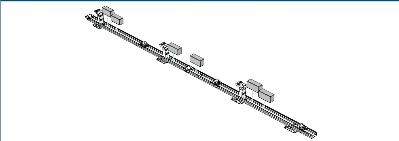
5 Setzen Sie die nächsten beiden Einheiten auf das Dach.
