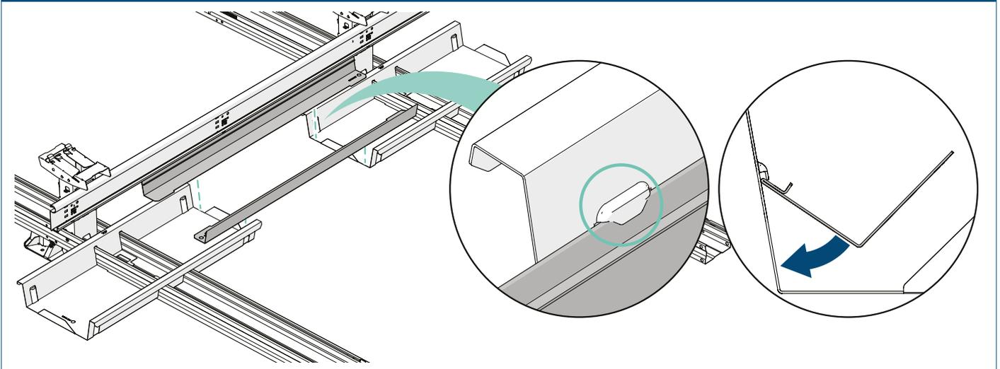
3 Füllen Sie die Ballastablagen mit Ziegeln.
